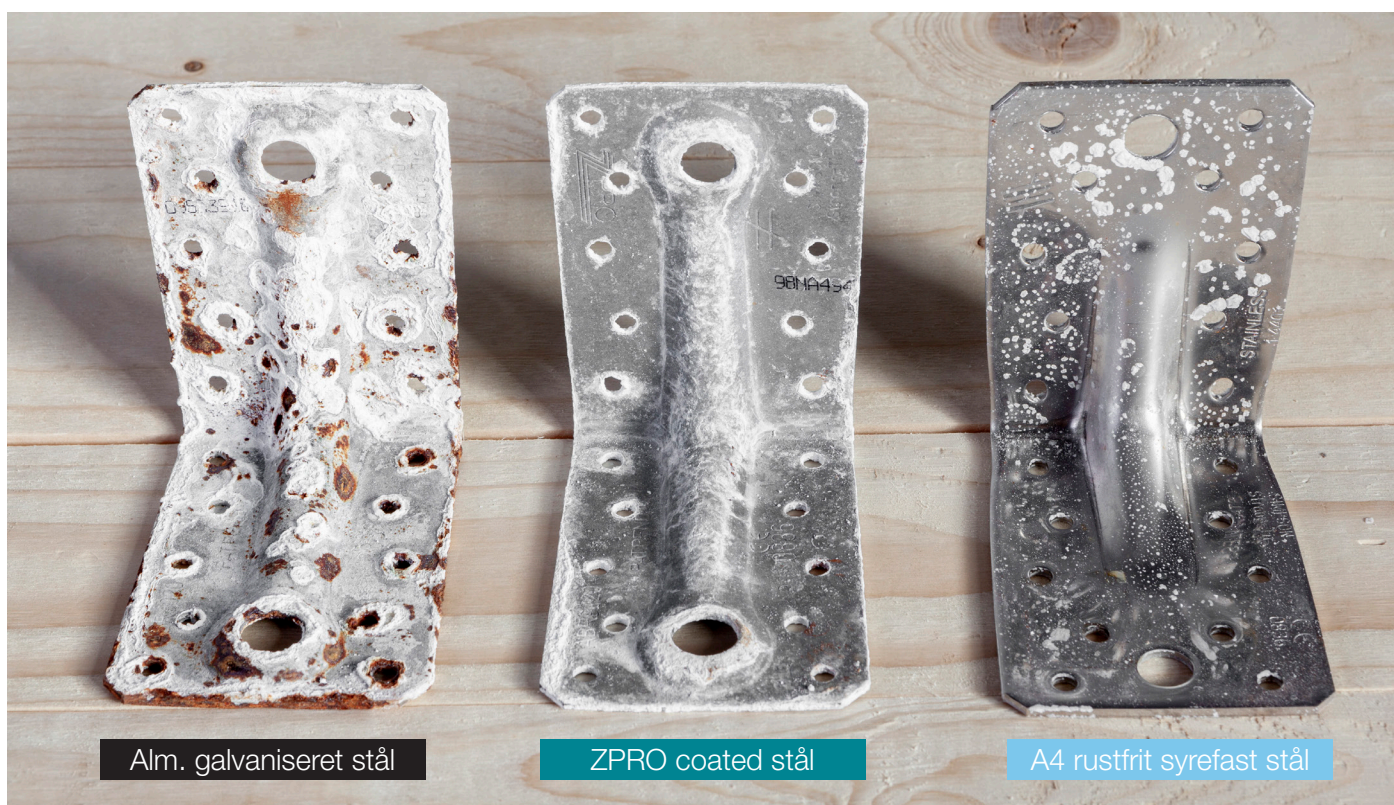
Billede 1: Resultat af cyklisk salttågetest - Normalt udendørs miljø - Tid: ca 14.000h (C3 = 12.000h-13.000h = ca. 15 år)
