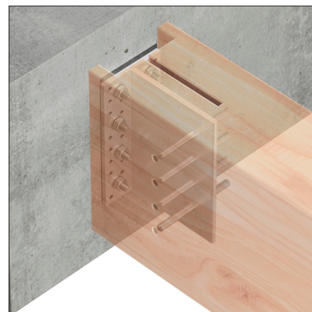
BTCALU fastgjort til betonunderstøtning ved hjælp af FM753 mekanisk anker og med SDD-dyvler installeret gennem finnen.
