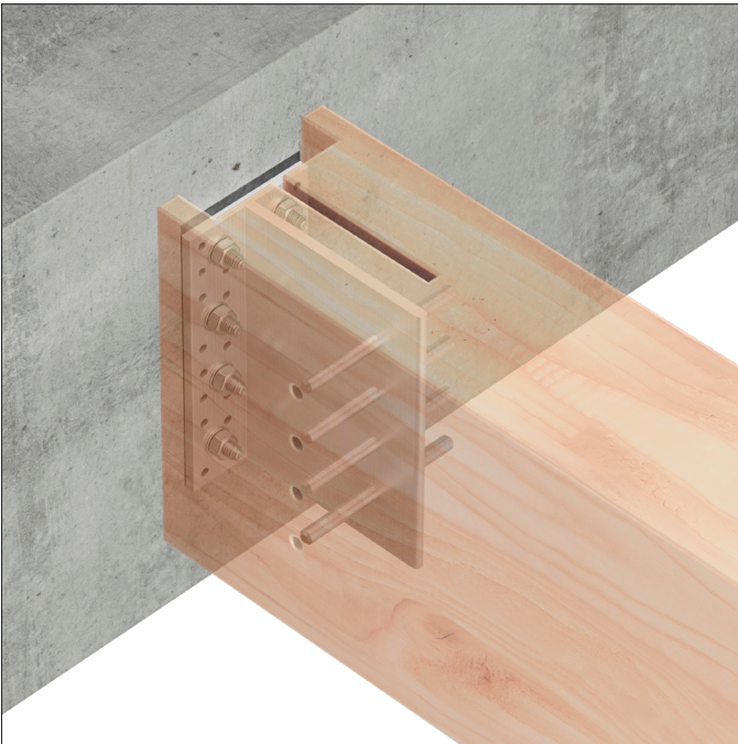
BTCALU-installation fra træ til stiv understøtning. Bemærk brugen af polyethylentape med lav grad af tæthed mellem beslaget og betonoverfladen.
