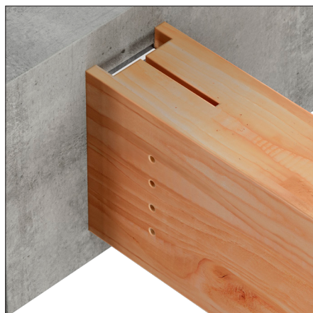
BTCALU fastgjort til betonunderstøtning ved hjælp af FM753 mekanisk anker og med STD dyvler monteret gennem finnen.
