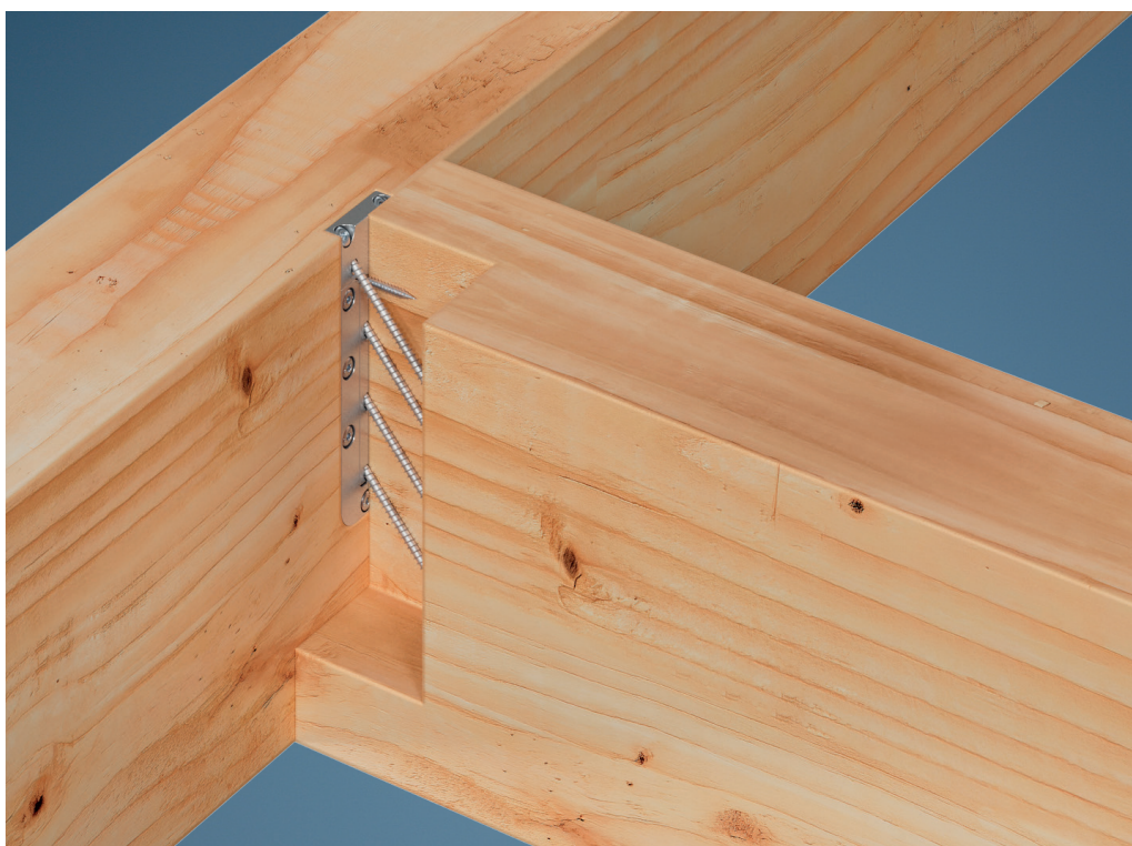
EGCL bjælke-til-bjælke samling i massivt træ med skjult montering (indfræst), der viser fastgørelseskonfiguration
